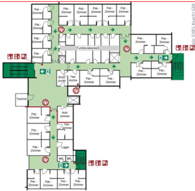
Abb. 3: Musterbeispiel für die kombinierte und wirtschaftliche Ausstattung und Verteilung wartungsfreier Feuerlöscher und Feuerlöscher-Sprays in einer Klinik
